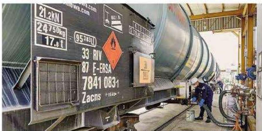
Lo scalo intermodale all'interno dello stabilimento Radici Chimica a Novara: una ferrocisterna durante le operazioni di scarico
