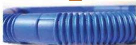
Condotta dell'aria estrusa in Radilon D 40EP25ZW 333 BK per il freno pneumatico di un autocarro (Foto RadiciGroup)
