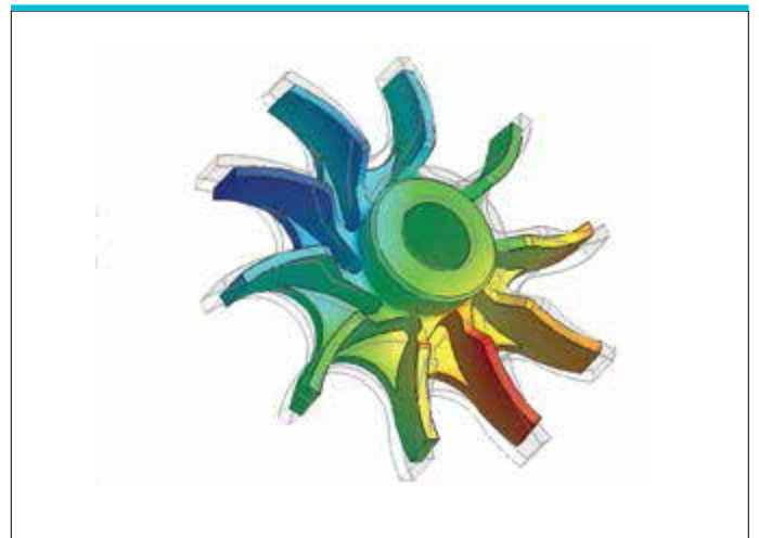
Figura 3 | Previsione del warpage di una girante pompa (scala visuale amplificata)
