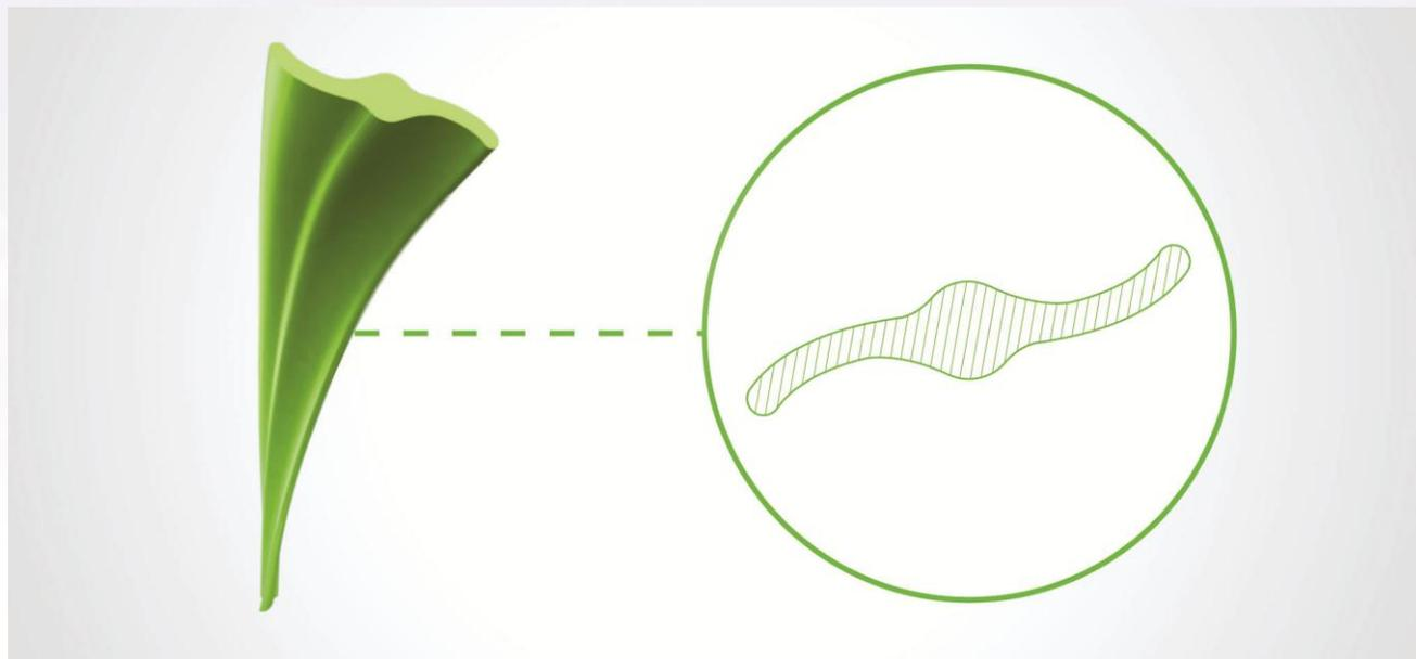
La sezione RADIGREEN® MFL PE S-CORE è il risultato di una progettazione particolarmente attenta alla resilienza e offre performance eccezionali in termini di ritorno verticale dopo il calpestio e conseguentemente garantisce ottimi risultati ai test di ball roll e biomeccanici, anche nel lungo periodo.
