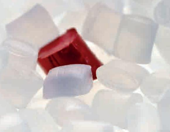
Le fibre sintetiche nascono dal saper produrre i polimeri. La chimica dei polimeri e l'adattabilità delle loro formule conferiscono alle fibre tutte le caratteristiche e i colori voluti. Nella foto intermedi chimici e granuli di polimeri naturali colorati e additivati
