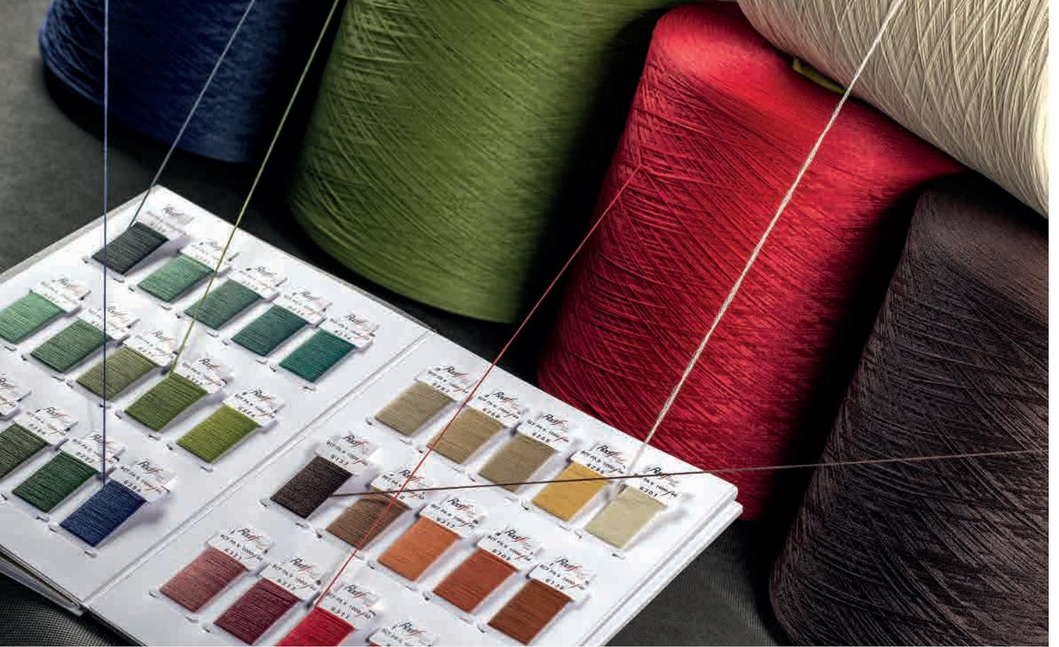
filatura, si è ottenuto un forte risparmio di acqua di processo (-90% rispetto alla tintura in filo), fattore che influenza positivamente anche i consumi energetici, ridotti circa del 60% rispetto al tinto in filo non essendo più necessario il riscaldamento dei bagni di tintura.
