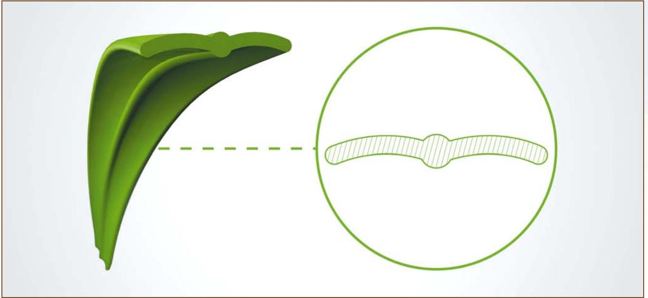
La nervatura centrale sostiene il filo senza creare evidenti differenze di spessore nelle varie parti che compongono il disegno della sezione.
