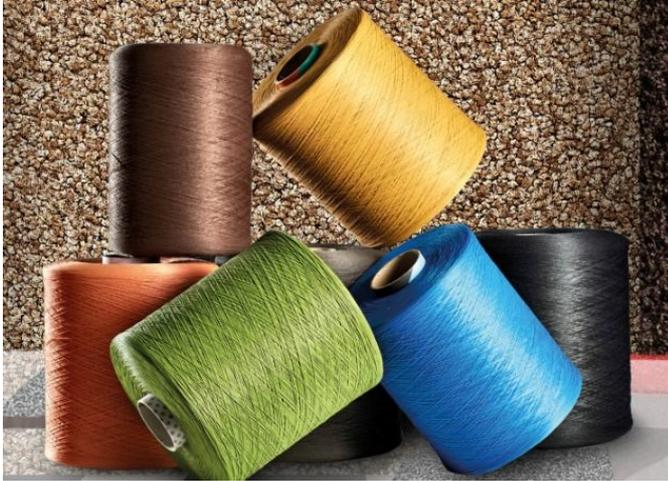
funzione in Radici Fil di nuove linee di filatura per la realizzazione di filati BCF di nylon 6.6 e di nylon 6 tinto in massa e di un nuovo reparto di interlacciatura ad aria, a Domotex 2013 il focus è sulla gamma prodotti in nylon 6, 700 e 920 dtex greggi. Presentata inoltre la nuova cartella colori dei fili BCF in PA6 1000 dtex e 40 filamenti Radifloor® Solid, prodotti ideali per applicazioni Contract come per esempio le "tiles" e per la
