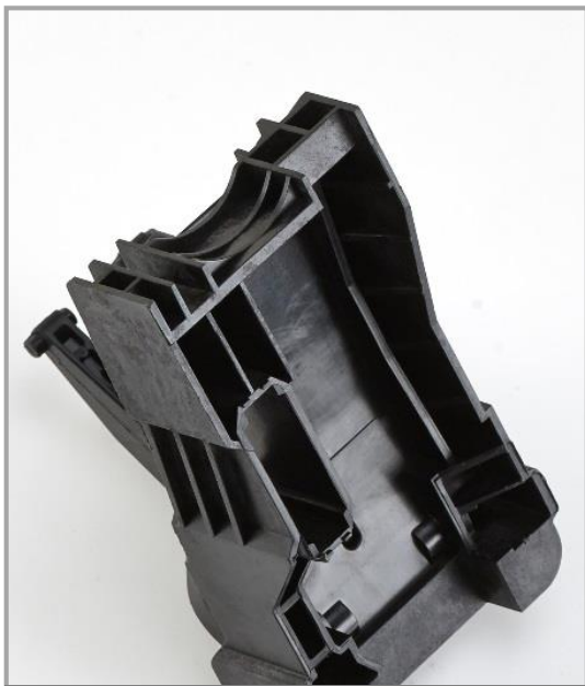
RADISTRONG® A LGF60W 3739 BK12 制动踏板支架，使用 PA6.6-LGF60 制造， 具有优异的抗蠕变性能、良好的耐冲击性 和耐热性。 应用领域：汽车。
